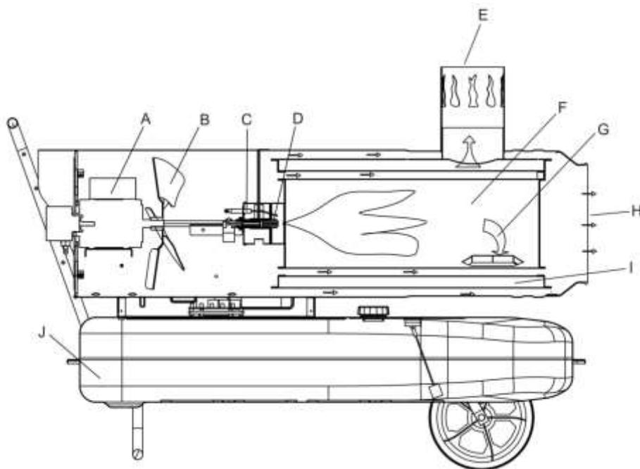
A. Двигатель B. Лопасть вентилятора C. Свеча зажигания D. Масляная форсунка E. Труба для отработанного воздуха F. Камера сгорания G. Выпускное отверстие для отработанного воздуха H. Выпускная труба горячего воздуха I. Распределительный колодец
