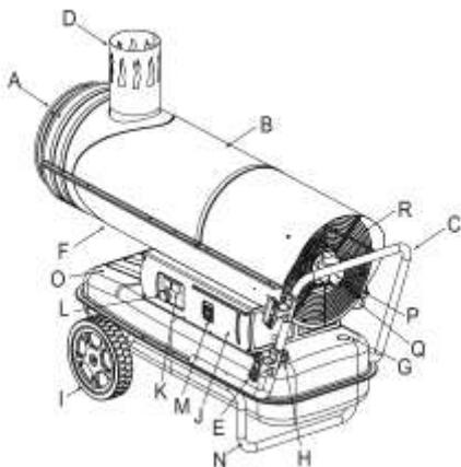
A. Выпускная труба горячего воздуха В. Верхний кожух С. Задняя ручка D. Выхлопная труба E. Держатель провода F. Нижний кожух G. Указатель уровня топлива Н. Крышка топливного бака I. Колесо J. Боковая крышка K. Цифровой индикатор температуры L. Регулятор термостата M. Выключатель N. Нижний трубчатый каркас O. Топливный бак P. Топливный фильтр Q. Насос высокого давления R. Защитная сетка.
